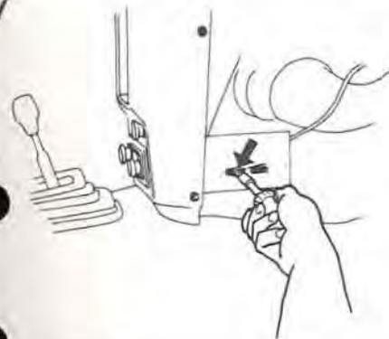
Skruva fast radion med bifogade fästskruvar på båda sidor.
