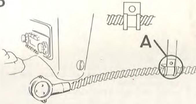
Borra  $\varnothing$  3,5 mm, och skruva fast uttagsdonet i kupén. Klamma kabeln i punkt A och sätt tillbaka losstagna delar.
