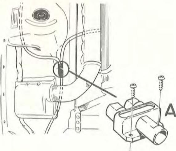
Anslut kabeln till insticksdonet. Om motorvärmare är monterad anslutes med en Y-kontakt A. Borra två hål, Ø 3,5 mm, och skruva fast kontakten.
