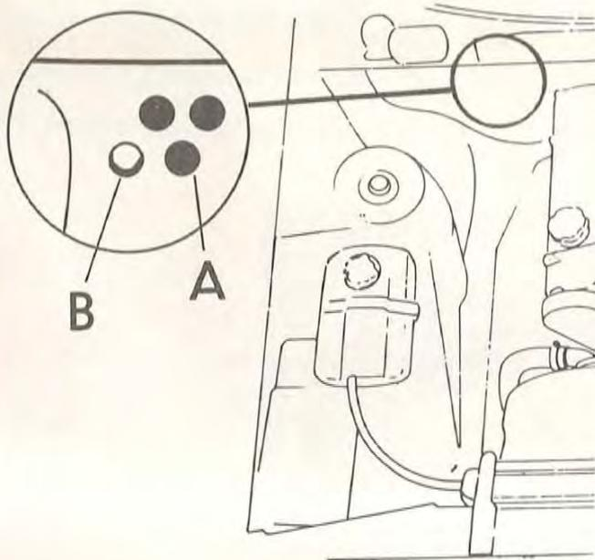
Skift ut gummiskiven A på mellombordet med gummigjennomføringen i settet. Stikk kabelen inn i kupéen.
