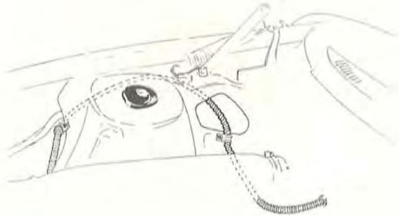
Klamma kabeln i hjulhustornets fram- och bakkant. Justera kabellängden.
