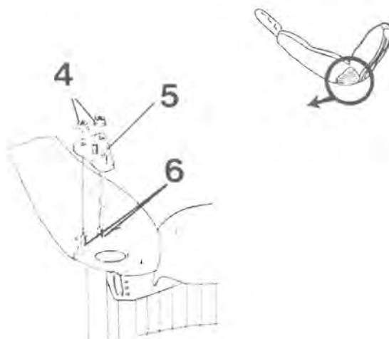
Tag bort muttrarna (4) och sätt dit konsolen (5) för armstödet, skruva tillbaks muttrarna.
