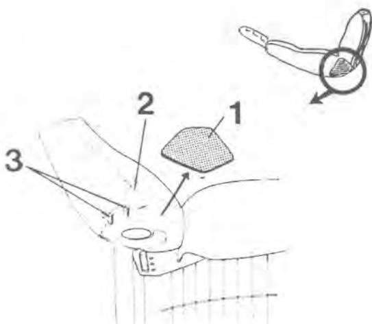
Tag bort plastkåpan (1) och vik upp klädseln (2) så att de två skruvarna (3) blir synliga.
