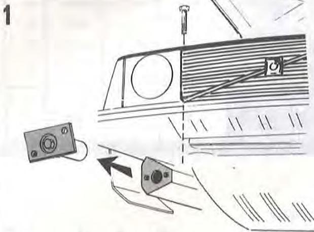
Ta bort stötfångaren och fästena som håller stötfångaren i framskärmarna.
