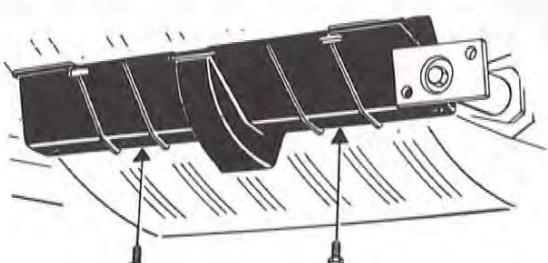
Haka fast kåpan för luftstyrning i plåtkanten framför kylaren.
