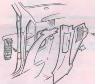
Montera kabelplattan till skarvstycket från spegeln.
