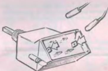
Montera strömförande kabel (röd) och jordkabel (brun) på de två yttre stiften på reglageknappen.
