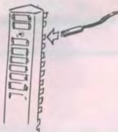
Montera strömförande kabel till säkring nr 3.
