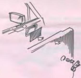
Återmontera avrinningspapp och dörrpanel.
