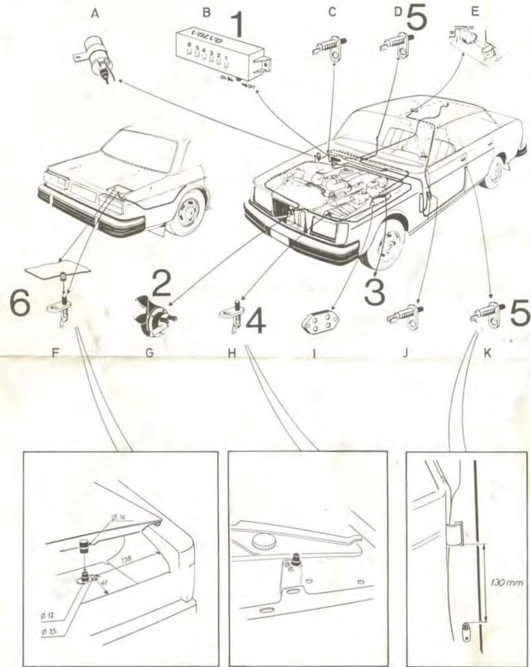
1. Ta bort en batterikabel. Skruva fast styrenheten B på lämpligt ställe — på mellanbrädan eller under instrumentpanelen.
