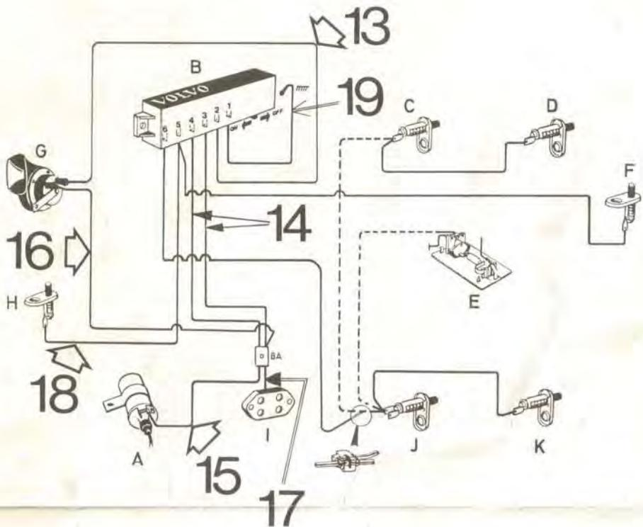
13. Anslut ledning med blå ledningssko till styrenheten — stift 2. Dra ledningarna till signalhornet och anslut blå ledningssko.
