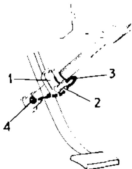
Montera vakuumkonsolen (1) rattöverfallets vänstra skruv
