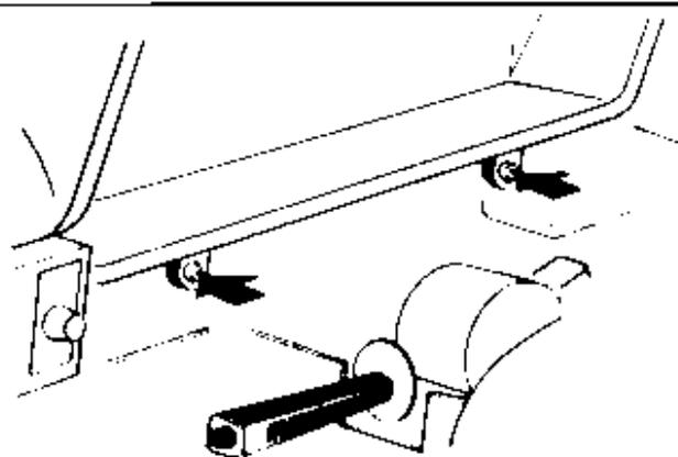
Lossa hastighetsmätarvarjern på baksidan av kombinationsinstrumentet. Lossa och dra ut instrumentet. Byt ut körvars-spaken mot spaken i sätset.
