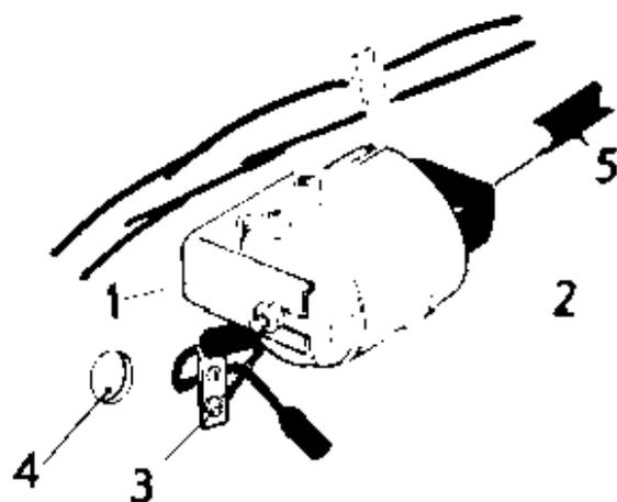
Sätt fast servokonsolen (1) och gumminellanläggel. Skruva fast servocylindern (2).
