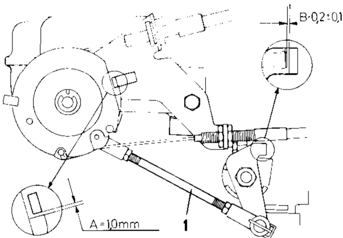
Justerä reglerstängen (1) så att när mått A är 1 mm skall mått B vara  $0,2 \pm 0,1$  mm.
