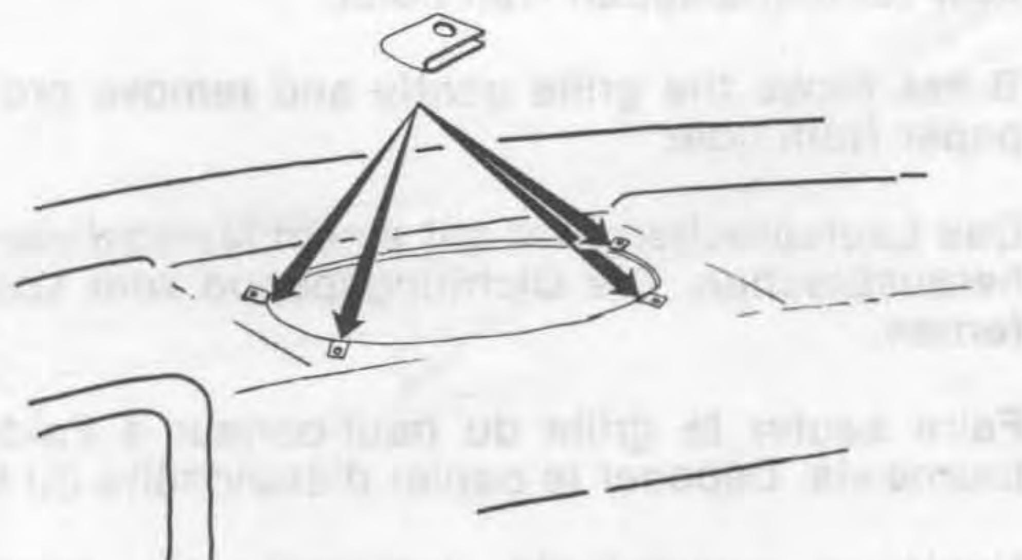
Montera plåtmuttrarna i kanten på högtalarhålet.
