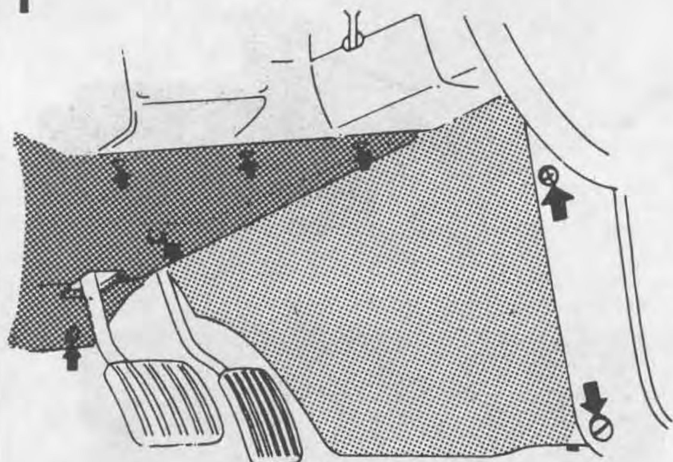
Lossa och vik ner isolerpanel under instrumentbräden.
